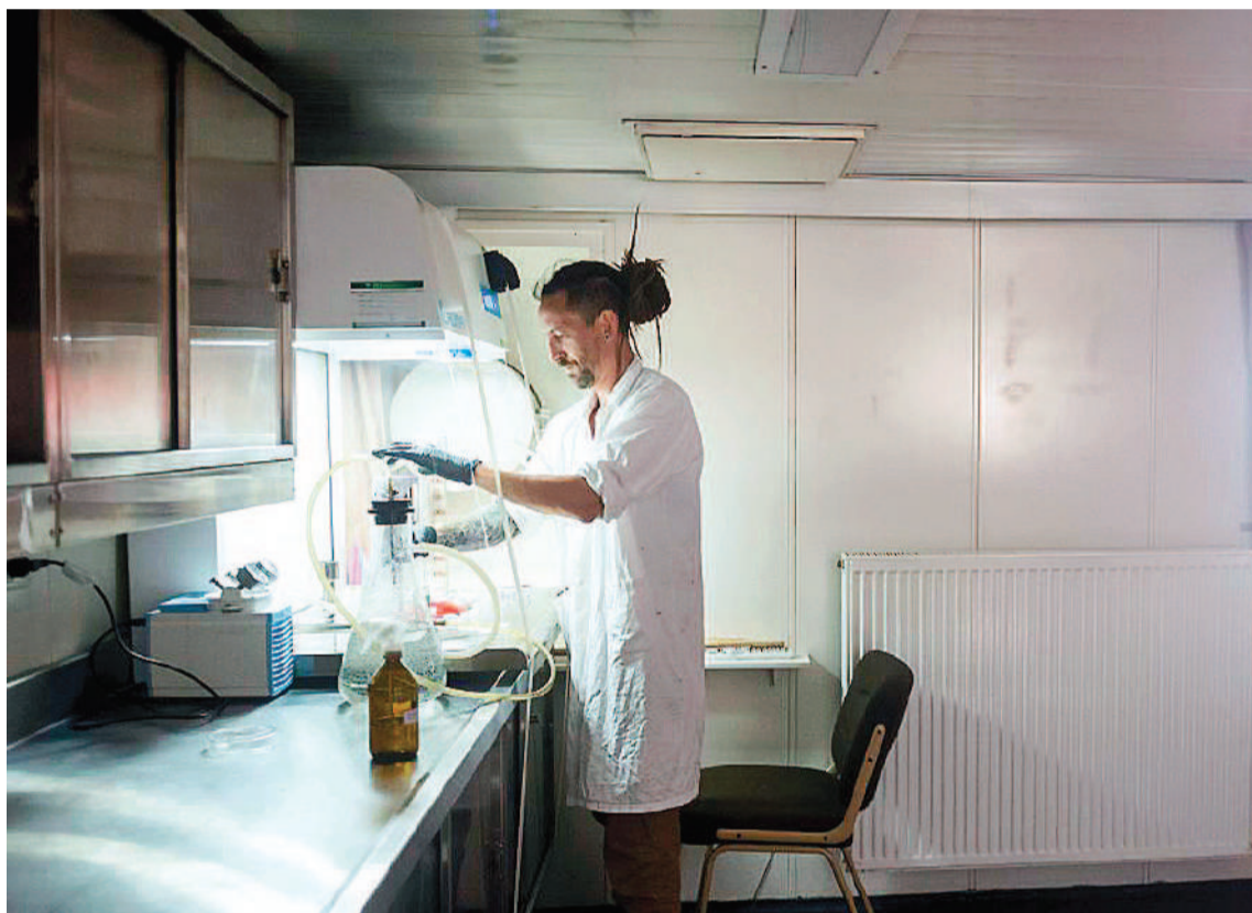
Los científicos filtran el agua que extraen de una canilla de agua de mar instalada en el laboratorio, lo que evita que deban salir a la intemperie del buque a tomar las muestras.
